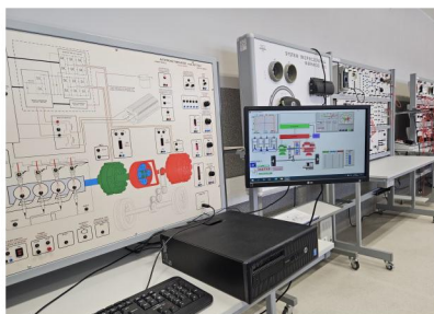
Symulacja napędu hybrydowego - pracownia mechatroniki pojazdów.
